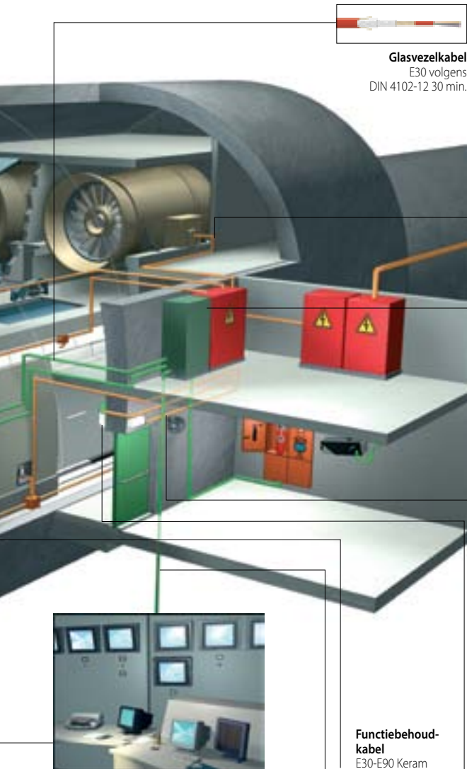
Glasvezelkabel E30 volgens DIN 4102-12.30 min.
