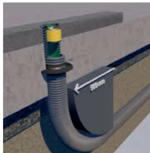
Bodemplaatvoer met muurkraag, Kabu-IN DD en Kabuflex R plus type 750 (minimale buigradius type 110 bedraagt 500 mm).
